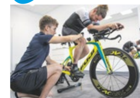
Lars Block analysiert per Knielot- und Satteldruckmessung die genaue Druckbelastung sowie die ergonomisch sinnvollste Sitzhaltung auf dem Rad.
